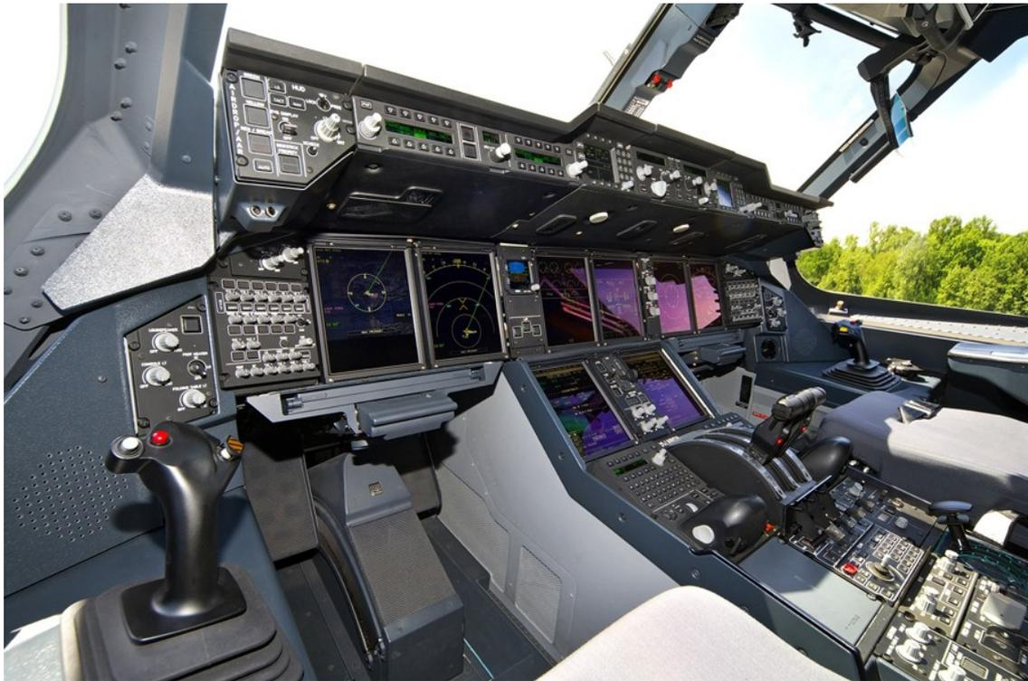
La nouvelle avionique de la dernière version de l'appareil intègre tous les avancées de conduite du vol soit en mode automatique intégral, soit en suivant les indications du directeur de vol. © Airbus
